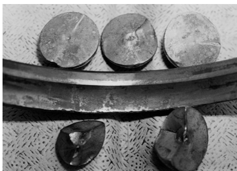
그림 15-5 깊은 홈 볼 베어링 외륜 궤도와 전동체의 깨짐
