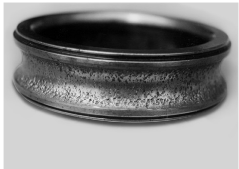
그림 15-2 깊은 홈 베어링 내륜 궤도에 발생한 플레이킹
