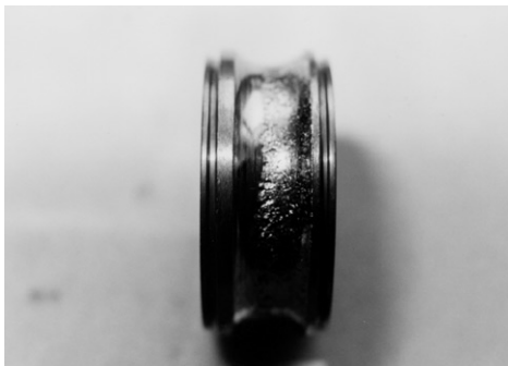
그림 15-1 깊은 홈 베어링 내륜 궤도에 발생한 플레이킹
