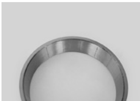
그림 15-7 테이퍼 롤러 베어링 외륜 궤도에 발생한 압흔
