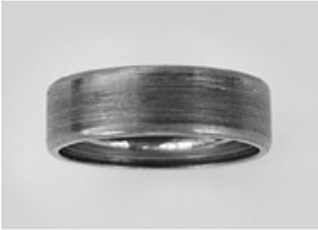
그림 15-9 깊은 홈 볼 베어링 외경면에 발생한 크리이프
